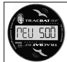
La modalidad REV muestra RPM o RPK para la cual la unidad ha sido programada.
